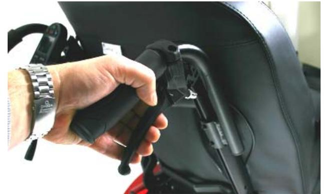
Palanca de accionamiento de la inclinación mediante actuador de gas
