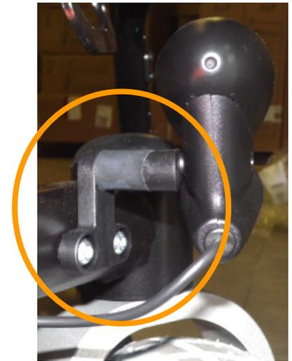
Sistema de sujeción de las luces delanteras de Led's
