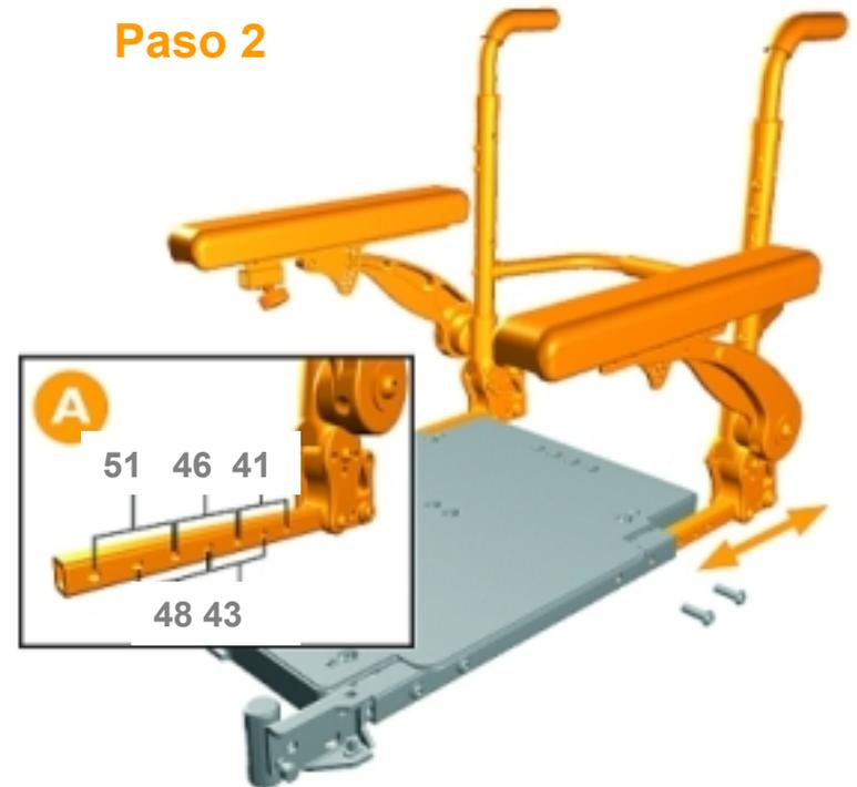
Y deslizar hacia atrás el conjunto del respaldo (coloreado en naranja) hacia delante o atrás en función de la profundidad deseada
