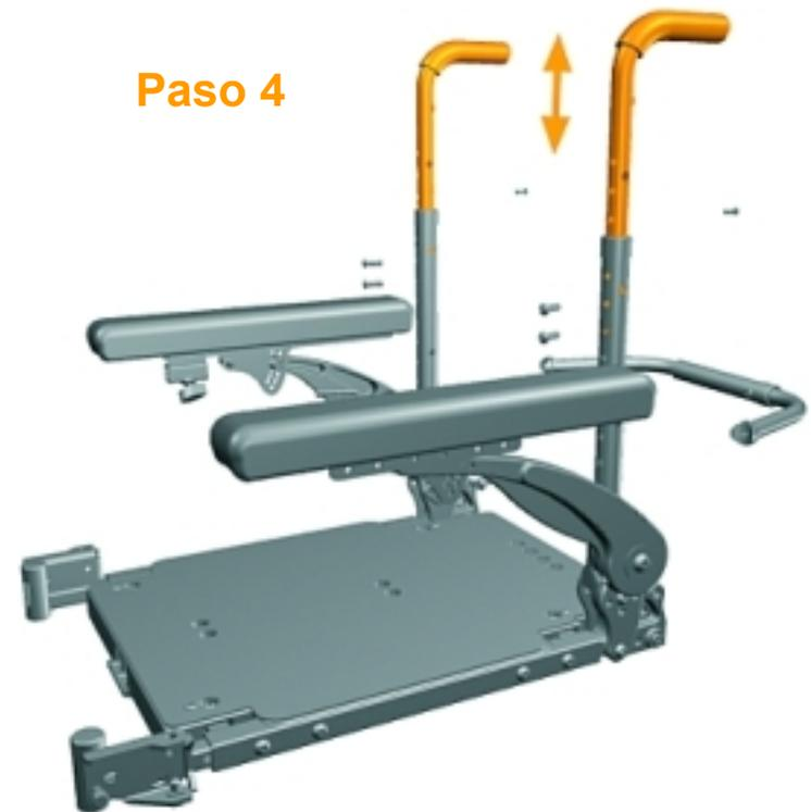
Ajustar a la altura deseada los tubos superiores del respaldo
