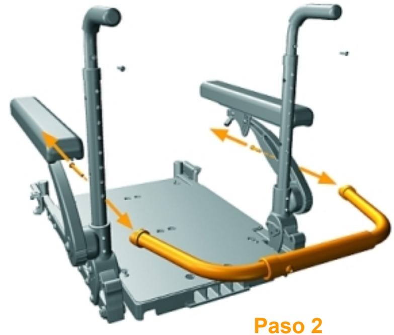
Soltar el tornillo que sujeta la barra rigidizadora a los tubos del respaldo
