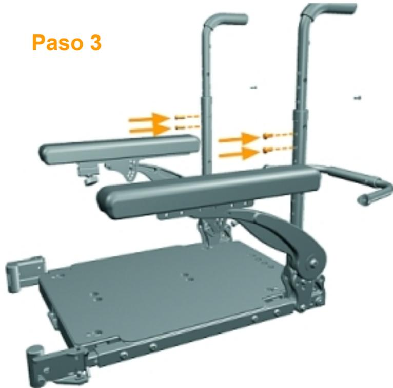
Soltar los dos tornillos delanteros del tubo inferior del respaldo
