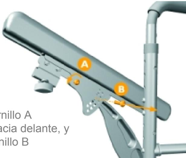
Aflojar el tornillo A girándolo hacia delante, y retirar el tornillo B
