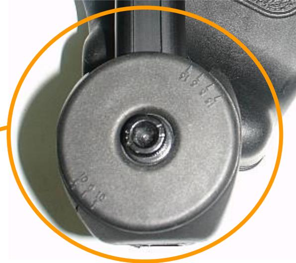
Soltar el tornillo allen central. Las dos piezas redondeadas tienen muescas internas que permiten la regulación en ángulo de la plataforma.
