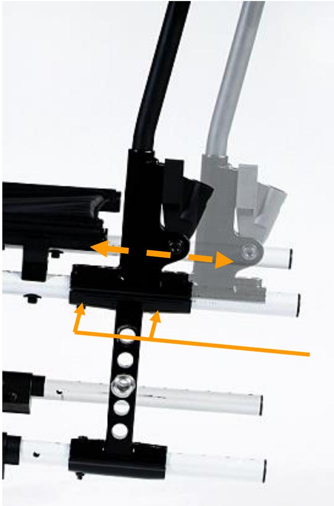
Soltando estos 2 tornillos, la pieza negra que soporta los tubos del respaldo queda suelta, pudiendo desplazarlos hacia delante o hacia atrás, para conseguir un ajuste en profundidad del asiento
