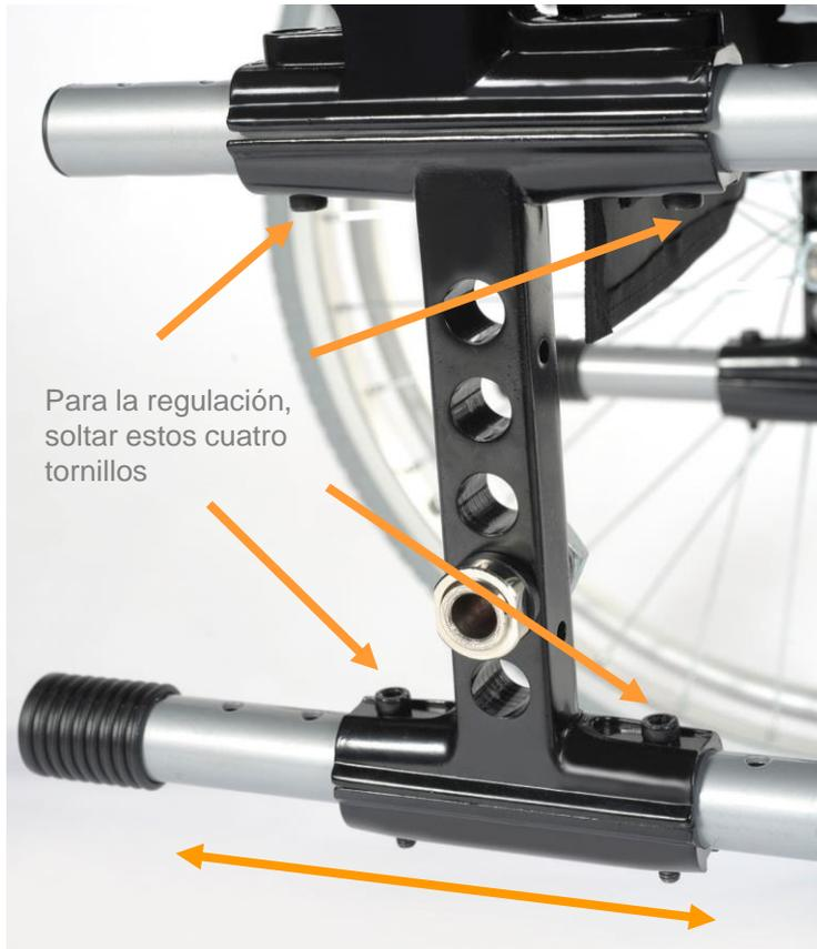
La pletina del eje puede colocarse hacia delante para una máxima maniobrabilidad o hacia atrás para mayor estabilidad.
