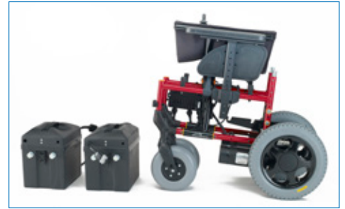
Uma vez tiradas as baterias e desmontado o encosto, a cadeira encarta de uma forma muito compacta.
