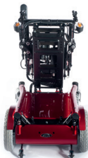
Acesso às baterias (Jive F tração dianteira)
