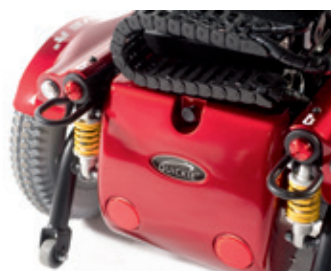
Fácil acesso às baterias desde a parte traseira da carcaça (Jive R 2 tração traseira)
