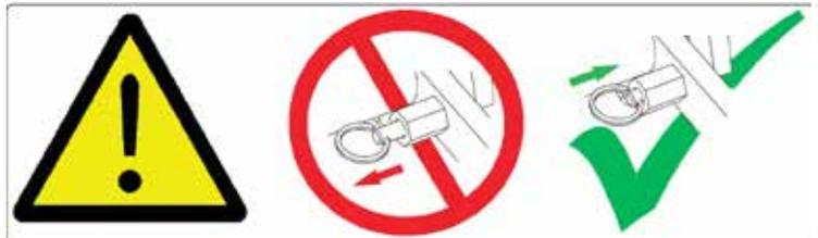
AVISO – Quando o assento for levantado, confirme se o pino de mola encaixa novamente na posição de fixação para segurar o banco na vertical.
