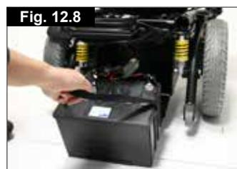
RWD: Para remover as baterias primeiro remova a tampa traseira. Depois, levante a placa do controlador (Fig. 12.7) e dobre a placa de suporte da bateria para baixo. Puxe as baterias para fora e desligue o conector Anderson (Fig. 12.8). Depois, puxe a segunda bateria para fora da mesma maneira.
