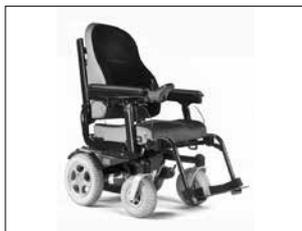
Peso total del ocupante con asiento Rehab (según prueba de peso): 160 kg
