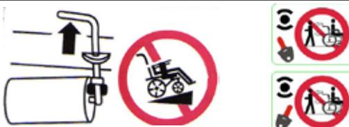
No embrague la palanca de liberación del freno en una pendiente.
