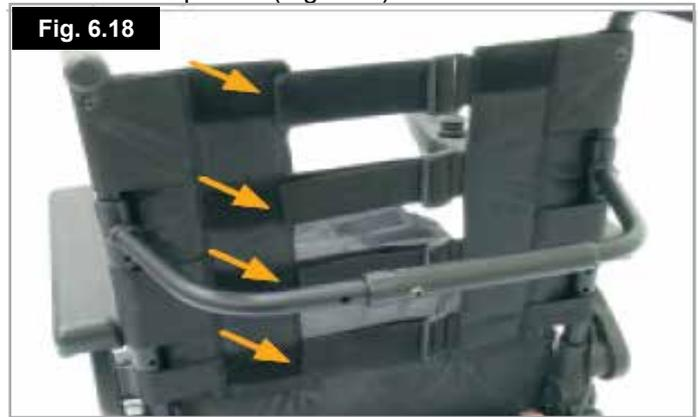
3. Extraiga los tornillos superiores de la tapicería. Ahora ya puede deslizar y comprimir la tapicería de manera vertical para obtener acceso a los tornillos Phillips ocultos (Fig. 6.19).
