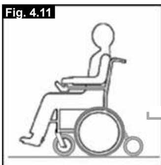
**Nota:** La medida máxima de escalón que puede superar es de 50 mm (100 mm con subebordillos instalado) para el modelo Salsa R2 (tracc. trasera) y 7,50 mm para Salsa M2 (tracc. central).
