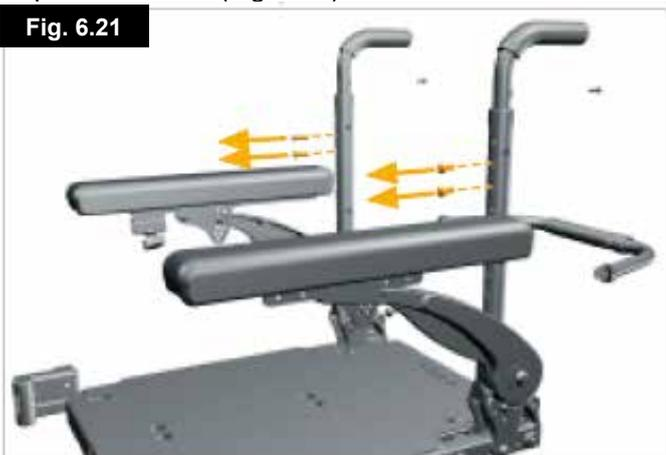
6. Deslice los tubos hasta alcanzar la altura deseada, (Fig. 6.22).
