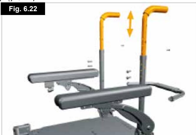
7. Vuelva a colocar los tornillos en los tubos del respaldo. Use una torsión de ajuste de 10 N/m o 88.5 pulg/lb (Fig. 6.23).
