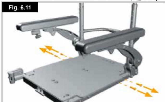
2. Deslice el conjunto de respaldo y reposabrazos hasta alcanzar la posición de profundidad de asiento deseada. Guía de posiciones de profundidad del asiento (A) (Fig. 6.12).
