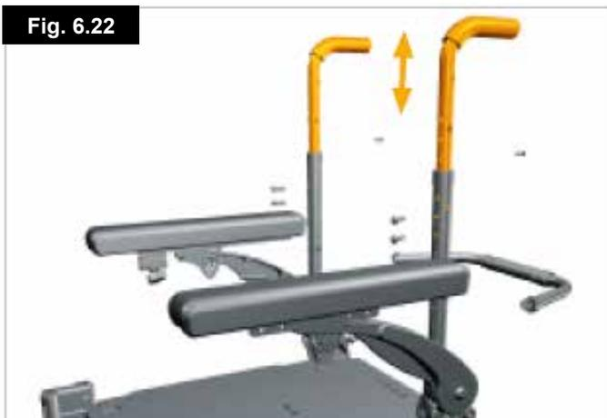
7. Volte a instalar os parafusos de ajustamento da barra traseira. Use uma chave de 10 N/m ou 88,5 pol/lb de força de aperto (Fig. 6.23).
