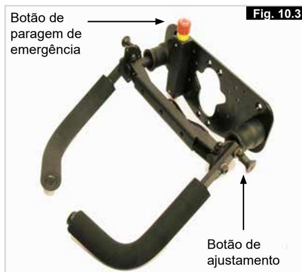
O mecanismo do manípulo Forus é centrado com molas que o reposicionam sempre na posição central quando as mãos do assistente largarem os manípulos. A altura dos manípulos pode ser ajustada libertando o pino de mola no lado, ajustando-o para a altura pretendida e libertando o pino. (Fig. 10.3)
