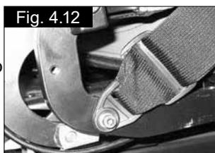
Instale uma anilha no parafuso. Passe o parafuso através do suporte de fixação do cinto de segurança. Instale a anilha seguinte no parafuso, (Fig. 4.13).
