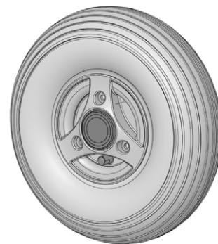
Imagem 87. Válvula de enchimento.
