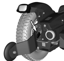
Imagem 77. Alavanca de desbloqueio dos travões com lingueta de segurança
