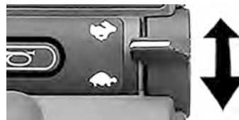
Imagem 66. No modo Bluetooth® o interruptor de patilha da direita é usado para navegar para cima ou para baixo.
