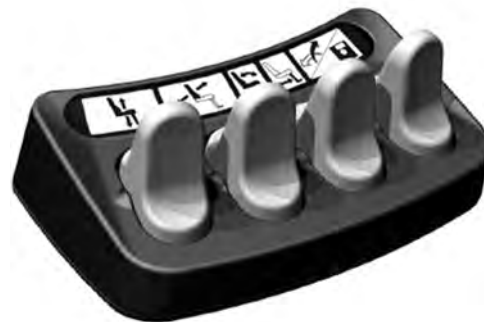
Imagem 102. Painéis de manobras ICS do assento, o de cima com botões de pressão e o de baixo com interruptores de patilha.
