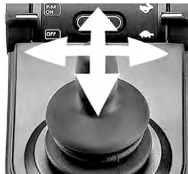
Imagem 67. Com a alavanca de controlo Bluetooth® pode assumir o controlo das funções do rato.
