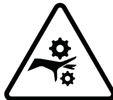
Imagem 7. Perigo de esmagamento.
