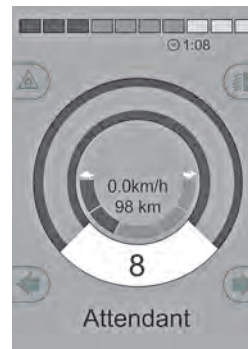
Imagem 85. Imagem padrão do visor com indicador de velocidade.
