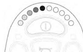
Imagem 161. Os LED no indicador de tensão da bateria.
