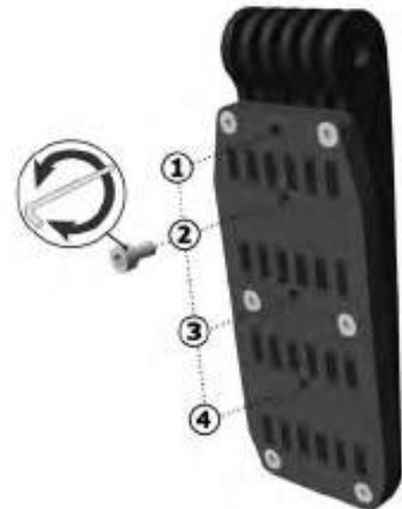
Imagem 41. Parafuso de ajuste da altura.
