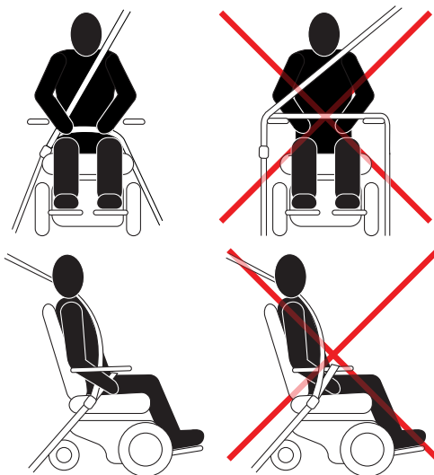
Imagem 146. As figuras da esquerda apresentam o posicionamento correto do cinto de segurança.
