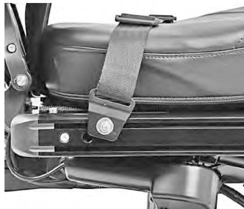
Imagem 36. Fixar o cinto de posicionamento.
