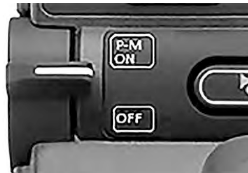
Imagem 46. Patilha de energia, modo e perfil.
