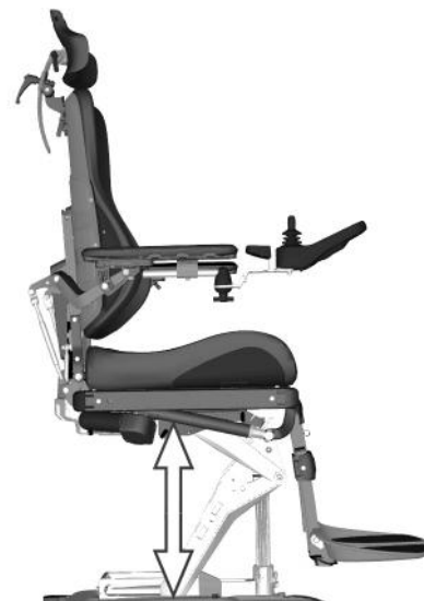
Imagem 11. Elevação do assento elétrica.
