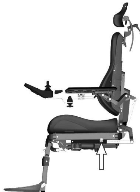
Imagem 17. Tubo de aperto manual para inclinação do encosto.
