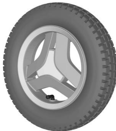
Imagem 163. Válvula de enchimento na roda motriz.
