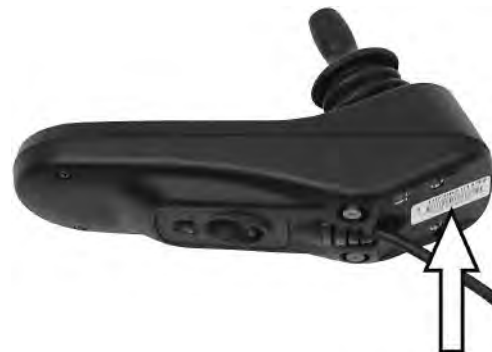
Imagem 150. Número de identificação do painel de manobras R-net.
