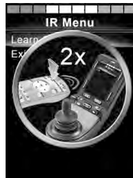
Imagem 90. Aponte o controlo remoto para o recetor IR. Carregue no botão duas vezes.
