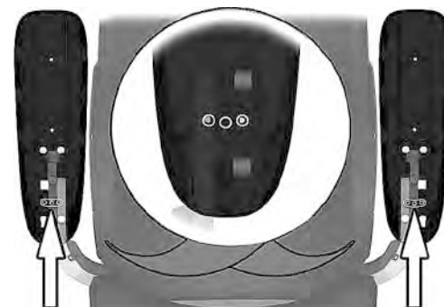
Imagem 25. Ajustar a posição final da rotação dos apoios de braços.
