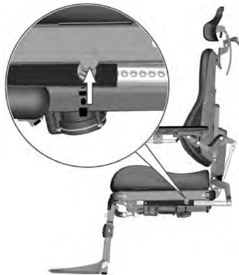
Imagem 19. Ajuste manual do ângulo do encosto.
