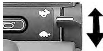
Imagem 82. No modo Bluetooth® o interruptor de patilha direito é utilizado para deslocar para cima ou para baixo.
