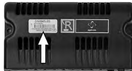
Imagem 149. Número de identificação do módulo de energia R-net.
