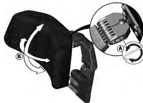
Imagem 43. Ajuste do ângulo do encosto de cabeça.
