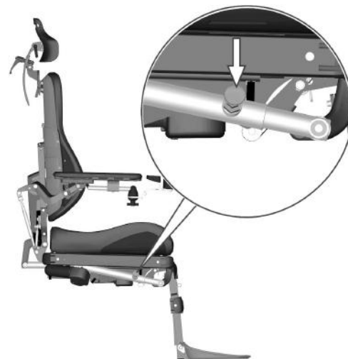
Imagem 18. Ajuste manual do ângulo do apoio das pernas.
