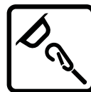
Imagem 143. Autocolante que mostra onde encontrar os ilhós de ancoragem.
