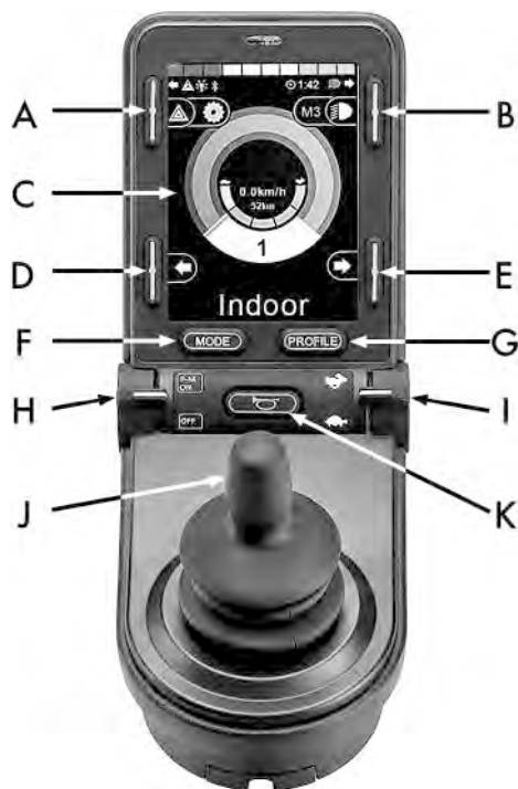
Imagem 44. Descrição geral do painel de manobras.
