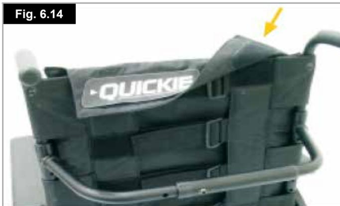
2. Allentare le cinghie del rivestimento. Non è necessario rimuovere il rivestimento, (Fig. 6.15).
