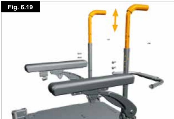
7. Riavvitare le viti per la regolazione dei montanti posteriori. Usare una coppia di serraggio di 10 N/m, (Fig. 6.20).
