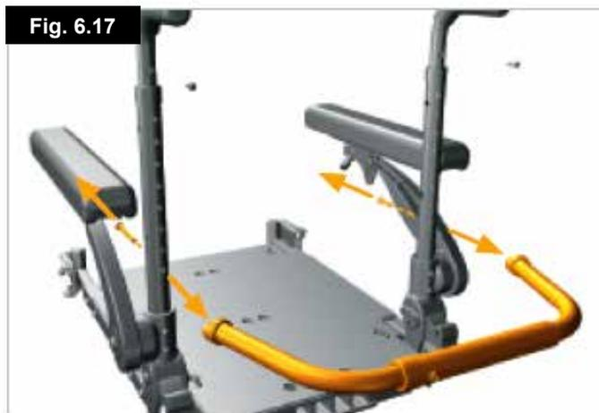
**NOTA:** Questo passaggio non è sempre necessario. A seconda dell'altezza delle manopole di spinta, la barra dello schienale potrebbe non essere avvitata ai tubi delle manopole di spinta. Per controllare, saltare questo passaggio ed andare ai punti 5 e 6. Se la barra dello schienale non impedisce i movimenti delle manopole di spinta, non è necessario rimuoverla.
