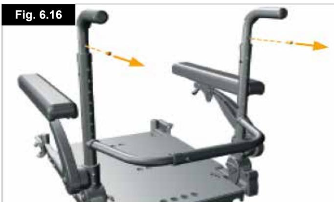
4. Rimuovere i bulloni da 4 mm della barra posteriore dello schienale e smontare la barra, (Fig. 6.17).
