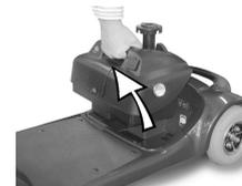
Pegue no manípulo na caixa da bateria, puxe o fecho da caixa da bateria (A) com o polegar e remova a caixa.
