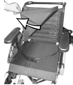
1. Remova a almofada do encosto (fixa com tiras de velcro), levantando e extraíndo, para aceder às faixas de regulação.
