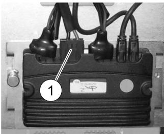
Retire o cabo de bateria (1) do módulo de alimentação.
