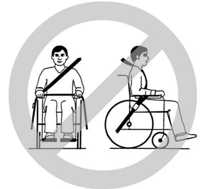
Os cintos de segurança não devem ficar afastados do corpo do utilizador devido a peças do veículo elétrico, tais como os apoios de braços ou as rodas.
